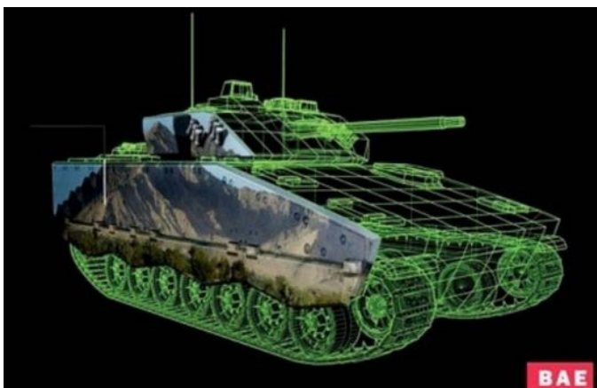
Figure 15 : disposition du papier électronique camouflant un char
