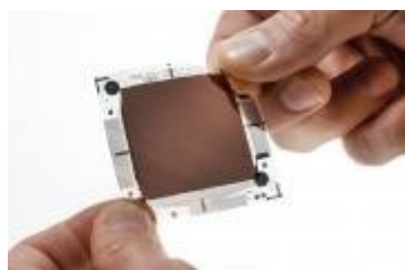
Figure 6 : capteur d'image imprimé sur plastique, de la société ISORG (source : ISORG).
