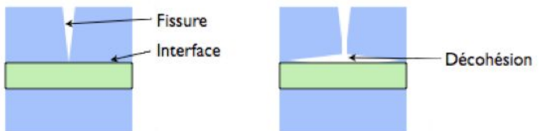
Figure 5 : Schéma du phénomène de décohésion au niveau de l'interface [1 : eduscol, 2011]
