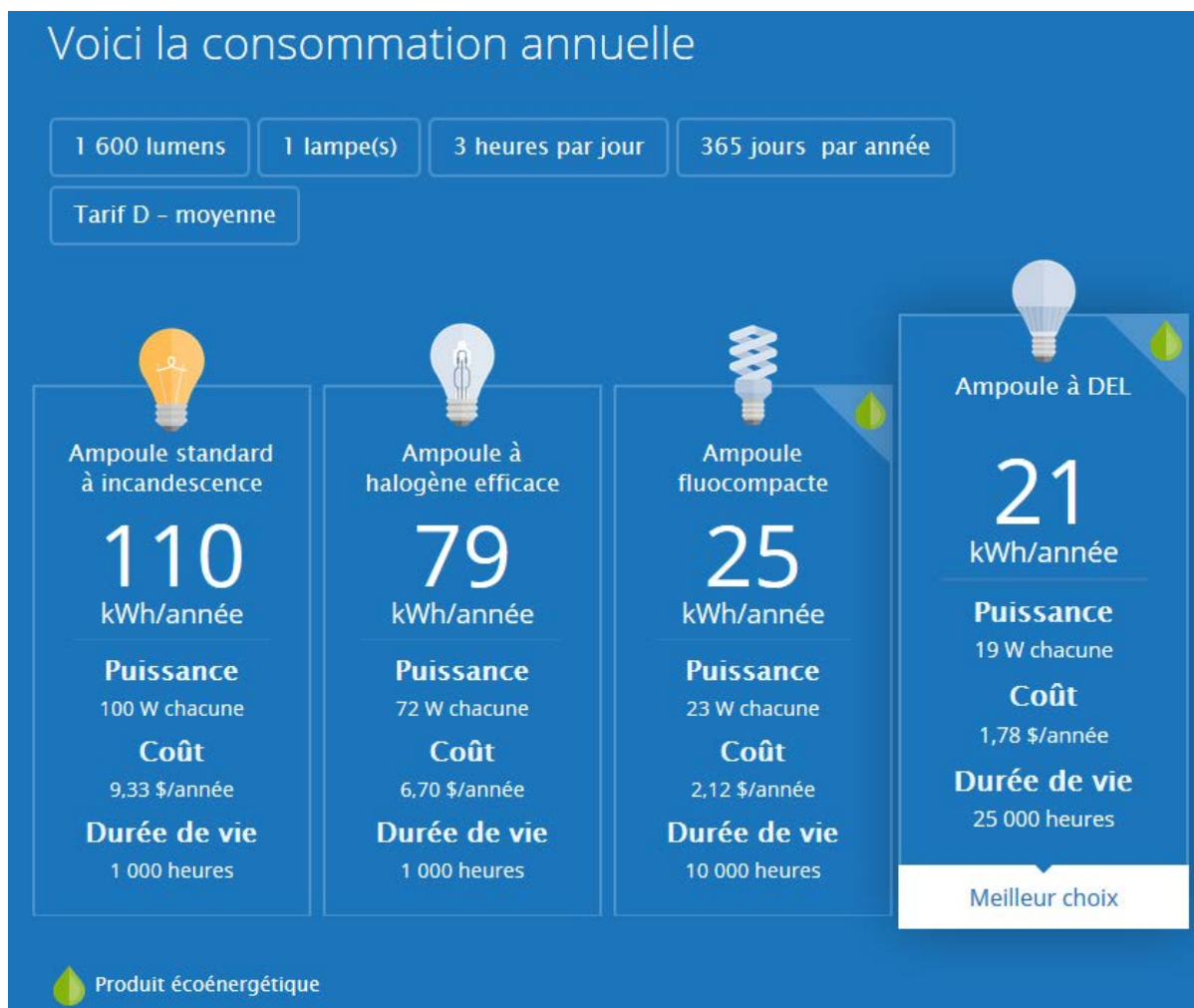
Figure 7 - Tableau comparatif de différents types d'ampoule selon HydroQuébec
