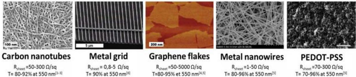
Figure 18 : Résistance et transparence des principaux substituants [1]
