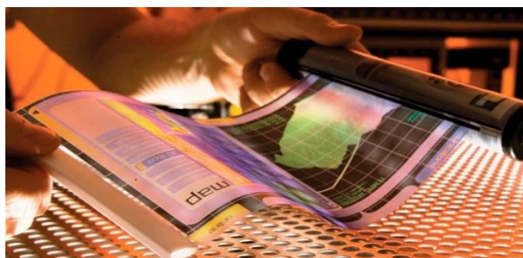
Figure 16. OLED imprimées sur un support flexible (source : lejournal.cnrs.fr)
