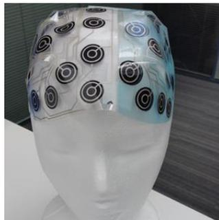
Figure 30 : Réseau de capteurs imprimés pour casque
