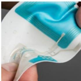
Figure 21 : Exemple de circuit imprimé flexible
