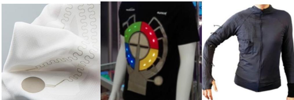
Figure 26 : Electronique extensible s'adaptant au corps (patches, vêtements), produit développé par Centi
