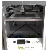
L'imprimante 3D Leapfrog par dépôt de fil fondu a été utilisée pour réaliser ces objets couche par couche en PLA, polymère biodégradable et biosourcé.
