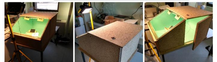
Banc d'essai réalisé pour tester les pare-soleil
